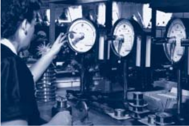
Feinwagen zur Bestimmung der Drahtstärken
