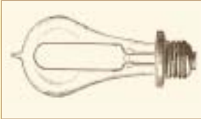
Edison Lampe mit Schraubsockel aus dem Jahre 1881
