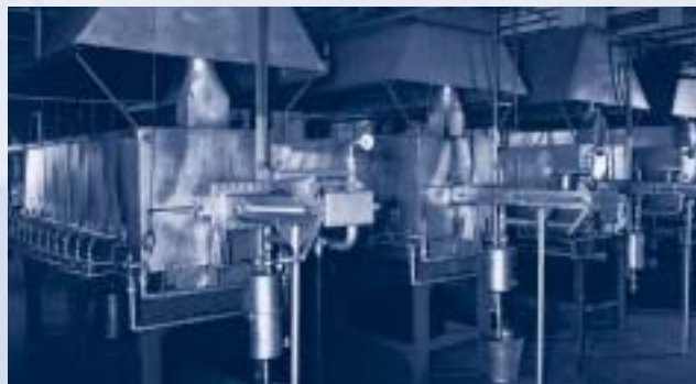
Reduzieröfen für die Wolframherstellung
