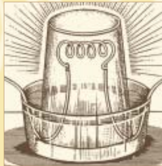
Platindraht Glühlampe von Grove 1840
